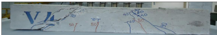
Figura 9 - Viga V4 após ruptura (CARNEIRO, 2013).
