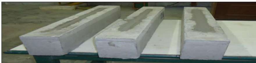
Figura 5 – Vigas, já reforçadas, em fase de cura (CARNEIRO, 2013).
